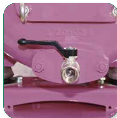
Valvola di scarico SU RICHIESTA: installata sulla portina serve per svuotare rapidamente il corpo pompa senza uso di attrezzi.
