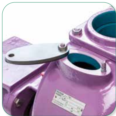
Portina di riempimento per riempire il corpo pompa al primo avvio e permettere l'innescaimento.
