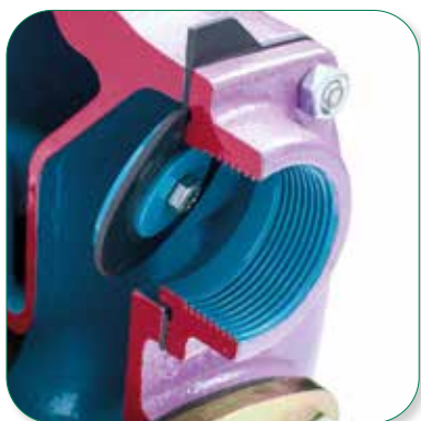
Valvola di non ritorno in aspirazione previene il reflusso di liquido dalla condotta di scarico e riduce i tempi di innescaimento. Disponibile in NBR, FKM, PTFE ed EPDM.
