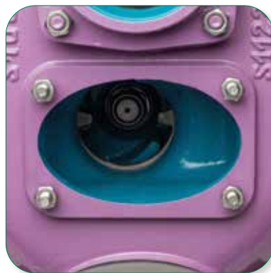
Portina di ispezione per verificare eventuali intasamenti della girante e per una rapida pulizia della macchina.
