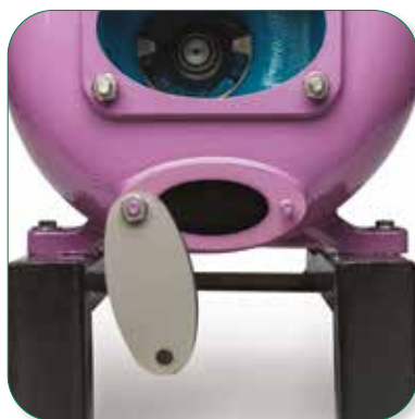
Portina di scarico serve a svuotare il corpo pompa, soprattutto nei mesi più freddi, per evitare che l'acqua geli al suo interno.
