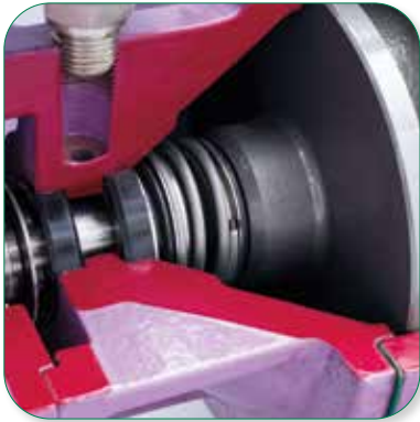
Gleitringdichtung mit Edelstahlwellenschutzhülse und Schmierung hinter den Gleitflächen, zur Verbesserung der Trockenlaufeigenschaften.
