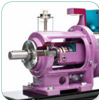
Опорная подкладка подшипник завышенного размера, регулировка ротора и каплесборника, встроенных в литой корпус.
