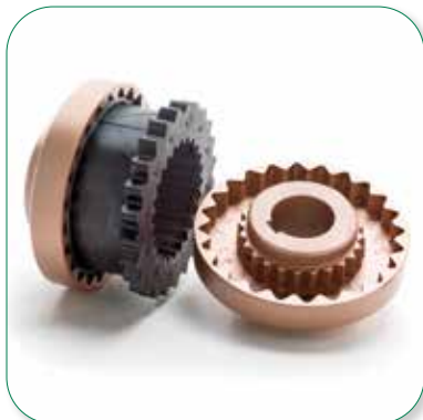
Муфта из SX упругая муфта для глушения шумов, вызванных работой двигателя и нерегулярным потоком. Центральный упругий элемент разрушается в случае блокировки насоса, защищая мотор и коробку передач.
